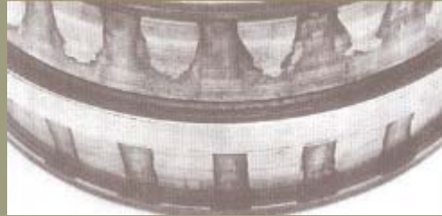
Attacco chimico esteso dovuto all'acqua presente sull'anello interno di un cuscinetto orientabile a rulli.
