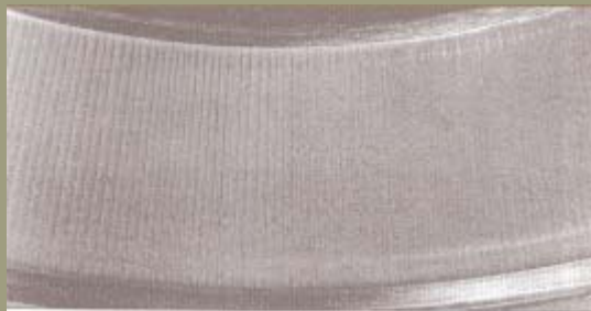
Anello esterno di un cuscinetto a rulli conici danneggiato da vibrazioni durante il funzionamento
