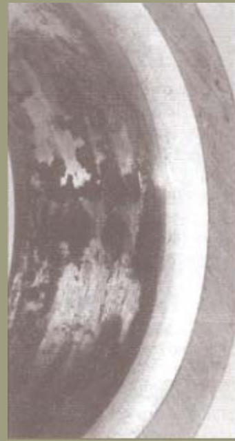
Ampio sviluppo di ruggine di contatto nel foro di un cuscinetto orientabile a sfere.
