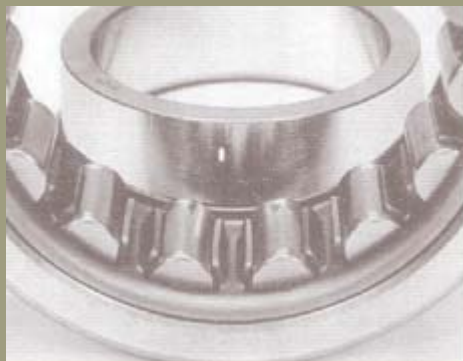
Cuscinetto a rulli cilindrici con striature sulla pista di rotolamento dell'anello interno e sui rulli a causa di errate operazioni di montaggio.
