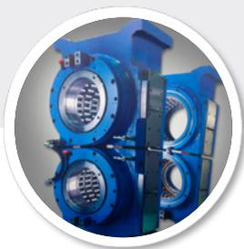
I cuscinetti a quattro file di rulli cilindrici vengono generalmente usati sui colli dei cilindri di laminazione, delle calandre e delle presse di laminazione. Sono particolarmente adatti per i laminatoi ad alta velocità. Grazie all'alta qualità delle piste di laminazione, la capacità di carico radiale è particolarmente alta. I cuscinetti a quattro file di rulli cilindrici sono smontabili, nel senso che l'anello esterno e le gabbie formano un corpo unico denominato "R", il quale può
