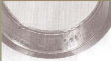
Tiefer Rost auf dem Aussenring eines Zylinderrollenlagers.
