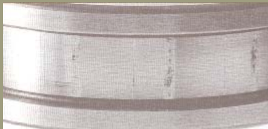
Innenring eines durch die Vibrationen beschädigten Zylinderrollenlagers. Die Beschädigung ergab sich bei einem nicht drehendem Wälzlager. Aufgrund der leichten Spuren zwischen den ausgeprägtesten Einlaufstellen (mit Korrosionen auf dem Grund) ist es offensichtlich, dass der Ring nur für kurze Zeit, die Stellung geändert hat.
