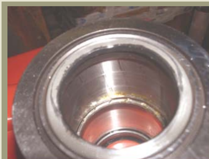
Beschädigtes Wälzlager auf den Führungskanten und auf den Laufflächen des Aussenrings aufgrund der Axialschübe.
