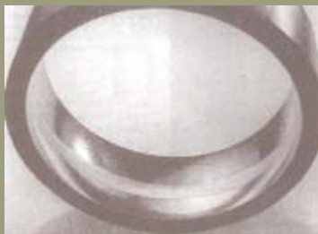
Aussenring eines ungeeignet geschmierten Wälzlagers; die Laufflächen sind hochglanzpoliert.
