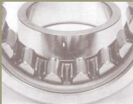
Zylinderrollenlager mit Streifen auf der Innenringlauffläche und auf den Wälzkörpern aufgrund falscher Montage.
