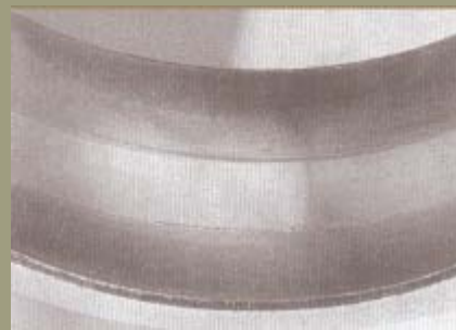
Aussenring eines Wälzlagers mit durch Abriebpartikel abgenutzte Laufflächen. Die Grenze zwischen dem abgenutzten Bereich und dem unversehrten Bereich kann leicht unterschieden werden.
