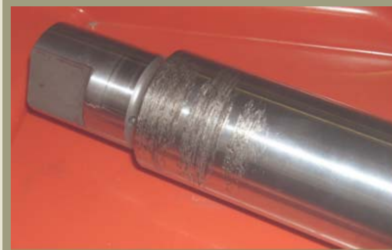
Bolzen mit Beschädigungen aufgrund eines Ausrichtungsfehlers; der nicht beschädigte Bolzenteil ist noch glänzend.
