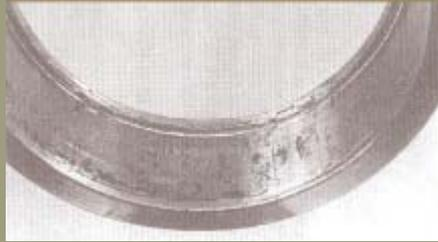
Rouille profonde sur la bague externe d'un roulement à rouleaux cylindriques.
