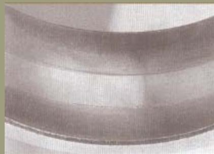
Bague externe d'un roulement orientable à rouleaux avec les pistes usées par des particules abrasives. Distinguer la limite entre la zone usée et la zone conforme est facile.
