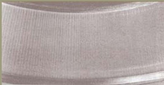
◀ Bague externe d'un roulement à rouleaux coniques endommagé par des vibrations pendant le fonctionnement.
