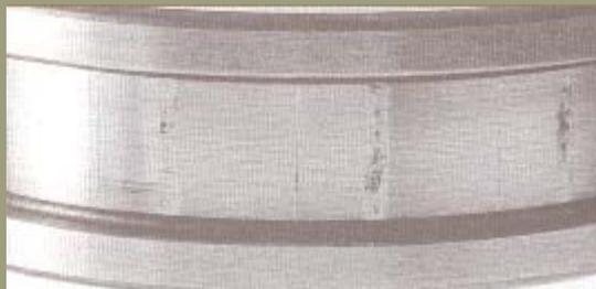
◀ Bague interne d'un roulement à rouleaux cylindriques endommagé par des vibrations. Le dommage s'est vérifié quand le roulement n'était pas en rotation. Si on regarde les traces les plus légères entre les affaissements les plus prononcés (et non pas des corrosions sur le fond), il est évident que la bague a changé de position pendant de brèves périodes.
