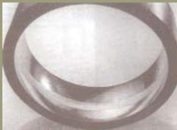
Bague externe d'un roulement orientable à rouleaux non lubrifiée selon les normes; les pistes sont polies « miroir ».
