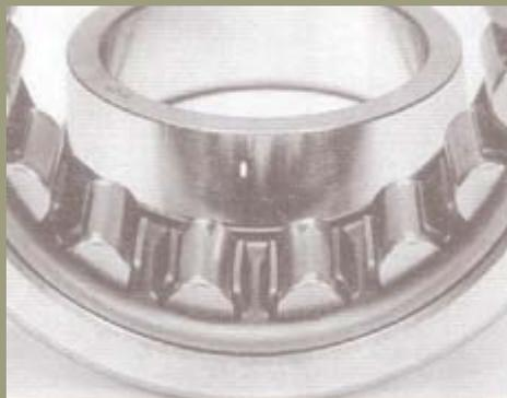
Roulement à rouleaux cylindriques avec rayures sur la piste de roulement de la bague interne et sur les rouleaux, à cause d'opérations de montage incorrectes.
