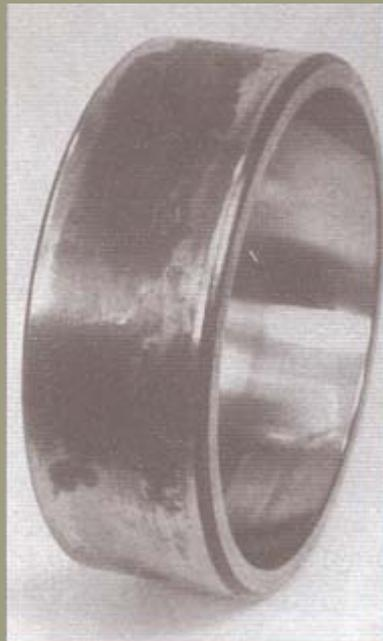
Rouille de contact ("fretting corrosion") sur la bague externe d'un roulement orientable.
