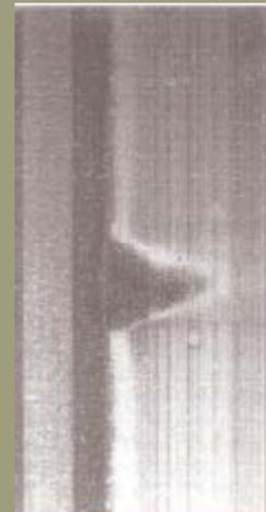
Dans cette situation, la distance entre les marquages est la même que celle entre les corps roulants. Dans les roulements à rouleaux, le dommage prend la forme d'un report de matière et, successivement, si la pression augmente, celle d'une marque.
