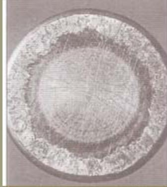
Tête d'un rouleau cylindrique avec d'évidents signes de report de matière à cause de charges axiales élevées et lubrification insuffisante.
