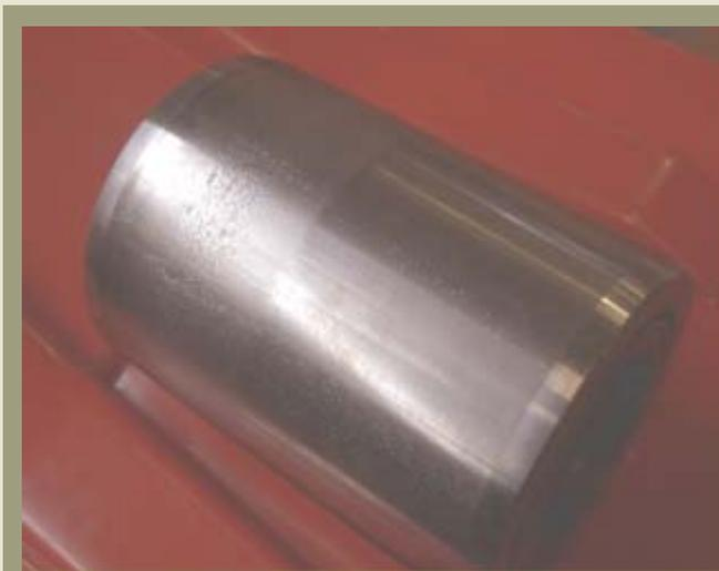
Bague externe avec signes évidents de mauvais fonctionnement du à un désalignement ; la partie de la bague externe non endommagée est encore brillante.
