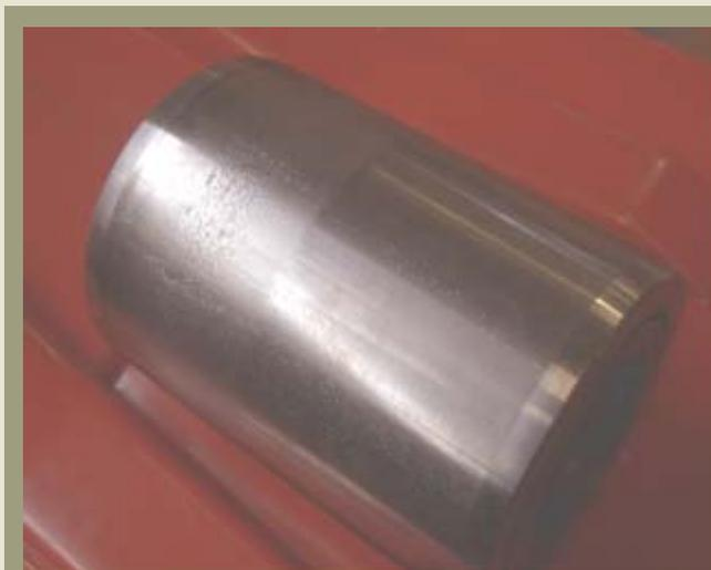
Anillo exterior con evidentes signos de mal funcionamiento debido al desalineamiento; la parte del anillo exterior no dañada presenta todavía un aspecto brillante.
