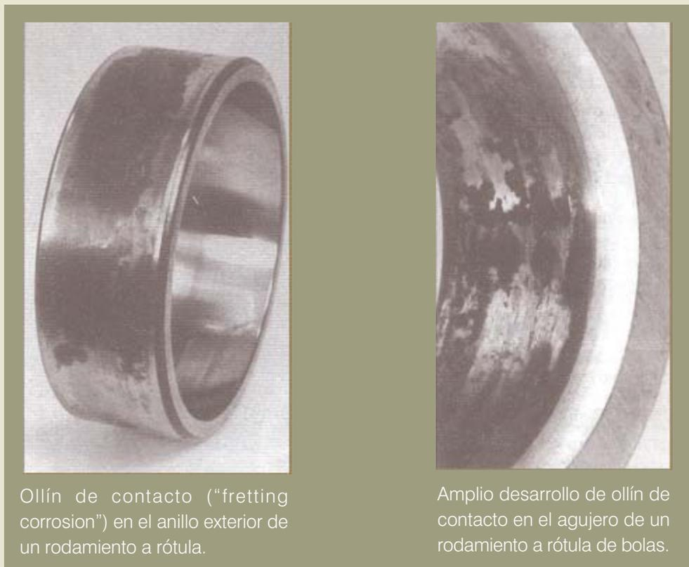
Olin de contacto ("fretting corrosion") en el anillo exterior de un rodamiento a rótula.
