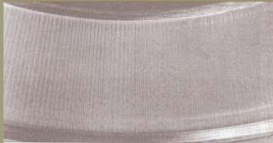
Anillo exterior de un rodamiento a rodillos cónicos dañado por las vibraciones durante el funcionamiento.
