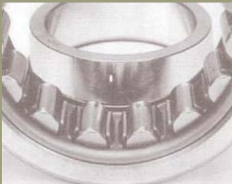
Rodamiento a rodillos cilíndricos con estrias sobre la pista de rodadura del anillo interior y sobre los rodillos a causa de equivocadas operaciones de montaje.
