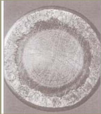
Cabeza de un rodillo cilíndrico con evidentes signos de arrastre de material a causa de cargas axiales elevadas e insuficiente lubricación.
