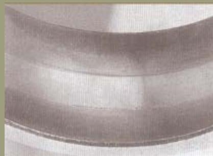
Anillo exterior de un rodamiento a rótula de rodillos con las pistas desgastadas por partículas abrasivas. Se observa claramente la marca de desgaste.
