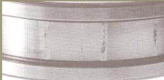
Anillo interior de un rodamiento de rodillos cilíndricos dañado por vibraciones. El daño se verifica cuando el rodamiento está en rotación. Tanto las huellas más leves existentes como las grietas más profundas (y con corrosión sobre el fondo) nos demuestran que el anillo ha cambiado de posición en breves momentos de tiempo.
