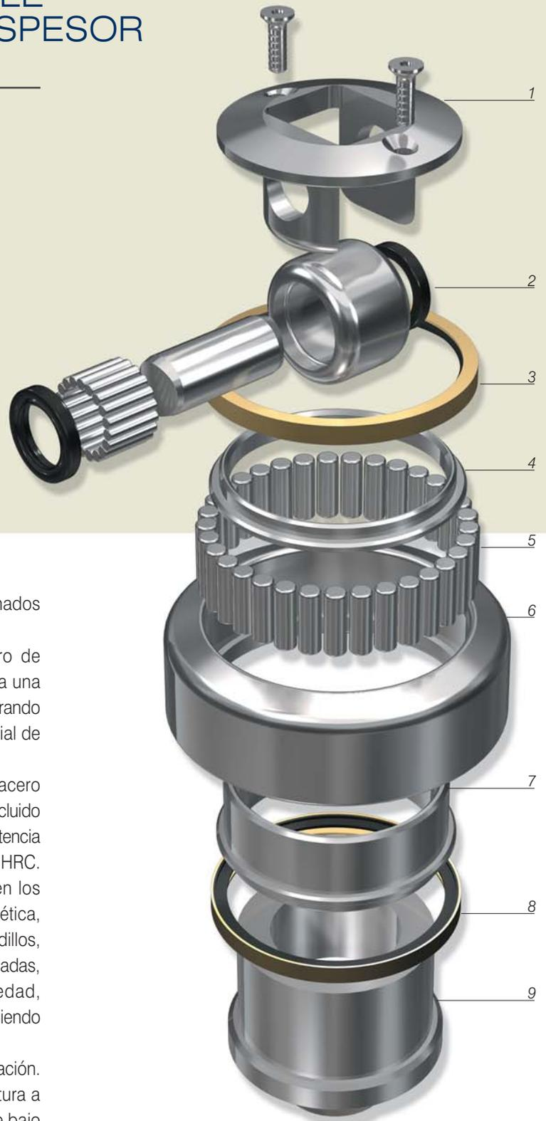
Características técnicas de los rodamientos combinados con axial ajustable por arandelas :
