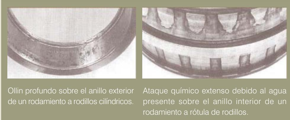
Olin profundo sobre el anillo exterior de un rodamiento a rodillos cilíndricos.
